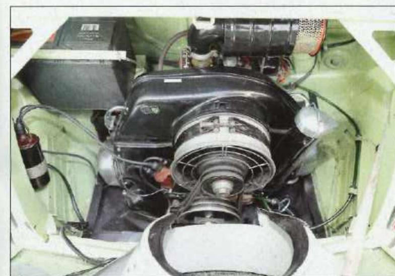
Le compartiment moteur n'a que les flancs et l'avant en commun avec la Nuova 500. Le boxer est surmonté et caché par l'immense ventilateur. Sur cette prise de vue, on n'entrevoit que la culasse gauche.
