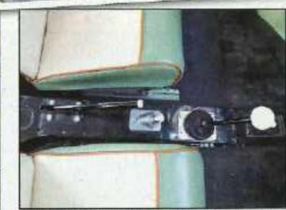
Il n'y a que le starter entre les sièges : le démarrage est intégré au Neiman.
