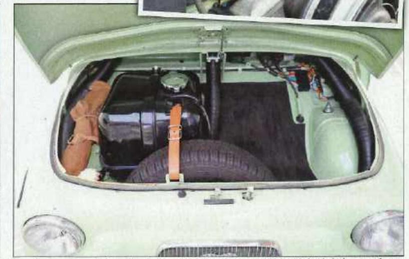
À gauche, on remarque le réservoir (qui peut contenir 3 litres de plus que celui de la Fiat), à droite le compartiment destiné au bagage (non le pluriel n'est pas possible), et au centre et à droite deux tuyaux qui transportent l'air frais vers l'habitacle.
