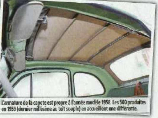
L'armature de la capote est propre à l'année modèle 1958. Les 500 produites en 1959 (dernier millésime au toit souple) en accueillent une différente.
